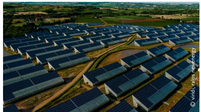
ABBILDUNG 3: Dachintegrierte PV-Technik auf Stallungen (links) und Gewächshäusern (rechts).
