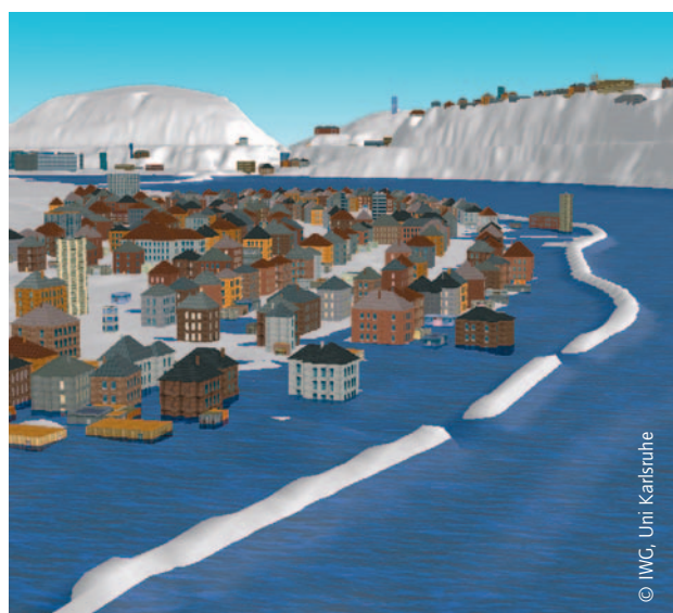
Abbildung 1: Flussmodelle, wie das Hochwassersimulationsmodell Neckar, liefern Basisdaten für Hochwasserwarnungen.
